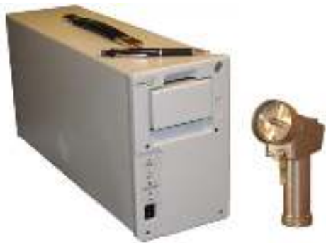
Рисунок 6 - Внешний вид портативного газового хроматографа ЭХО-В с дистанционным вихревым пробоотборником
